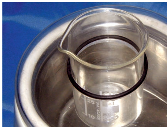
Предстерилизационная очистка и дезинфекция инструментов осуществляется в соответствующем моющем растворе под воздействием ультразвука.
